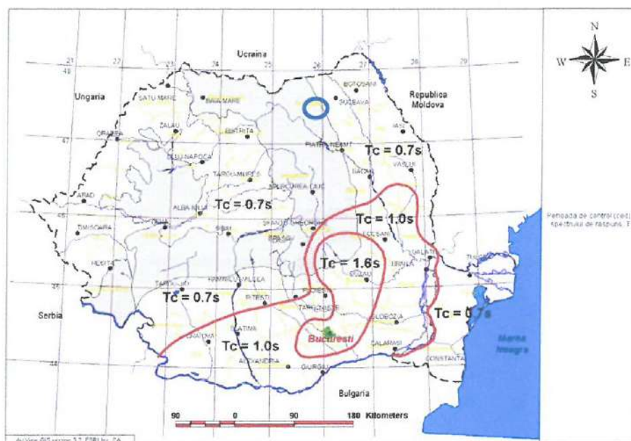
Fig. 2. Perioada de control (colț) a spectrului de răspuns ( T_c )
